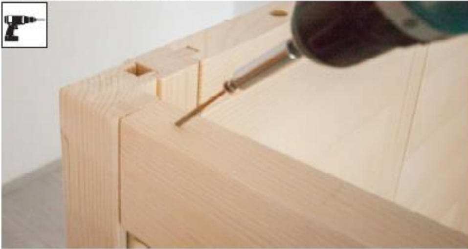
Burghiu de 3 mm, 2 șuruburi 4 x 70 mm
