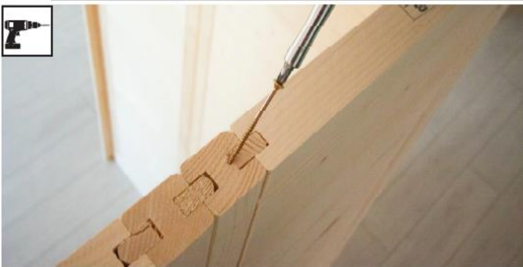
Burghiu de 3 mm, 9 șuruburi 4 x 70 mm
